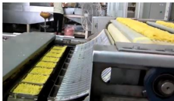
8. Noodles entering frying chamber フライ過程前の麺
