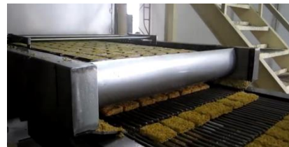
8. Noodles out from frying chamber フライ過程後の麺
